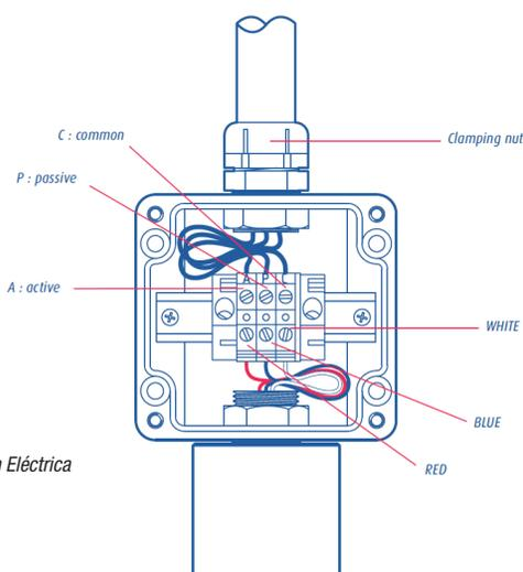
Figura 5: Conexión Eléctrica
