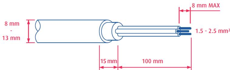
Figura 4: Cable pelado
