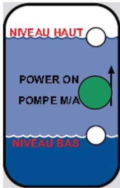
GPS 10 sous tension. Niveau du réservoir en position haute > la pompe est mise à l'arrêt. Statut conservé jusqu'à ce que le niveau bas soit atteint ou que le bouton Start est actionné.
